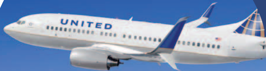
Im neuen Engineering Test Center werden u.a. innovative Flugzeugleichtbauteile der FACC AG getestet und geprüft – im Bild treibstoffsparende Split Scimitar Winglets (Flugzeugspitzen), die auf den Boeing 737 NG-Flugzeugen von United Airlines zum Einsatz kommen. Bild: FACC AG
